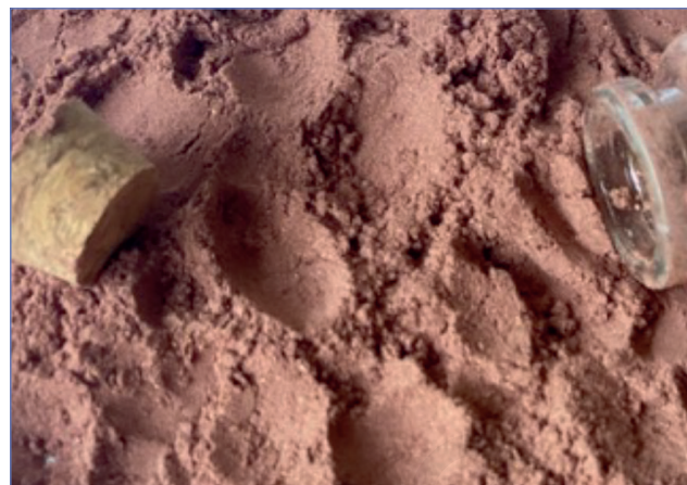
Figura 1 • Estratto essiccato ottenuto con la tecnica dello spray drying.
